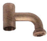
Piquage coudé à 90° à joint plat gaz à braser sur cuivre • Livré avec joint aramide : tous gaz.
